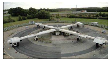
Essai au manège de fatigue IFFSTAR
